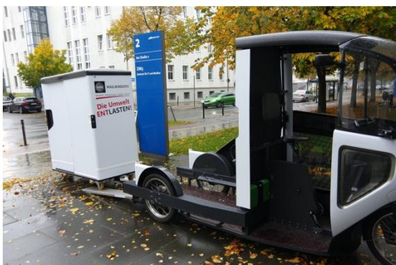
Der Fracht-Container lässt sich mit wenigen Handgriffen abmontieren.
