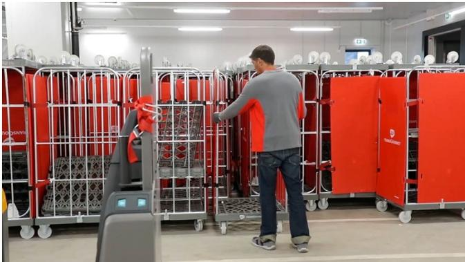
Roll-Safe im Einsatz: Die Mehrweg-Strukturkammerplatten kleben bei der Kommissionierung nicht aneinander wie mit Folie umwickelte Rollbehälter.
