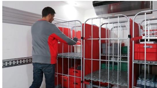
Die Rollbehälter kleben mit Roll-Safe beim Transport im Lkw nicht aneinander, sodass die Lkw schneller be- und entladen sind.
